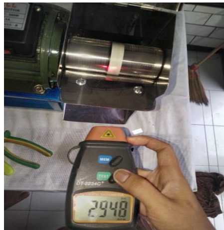
Gambar 8. Proses Pengujian Tanpa Beban
