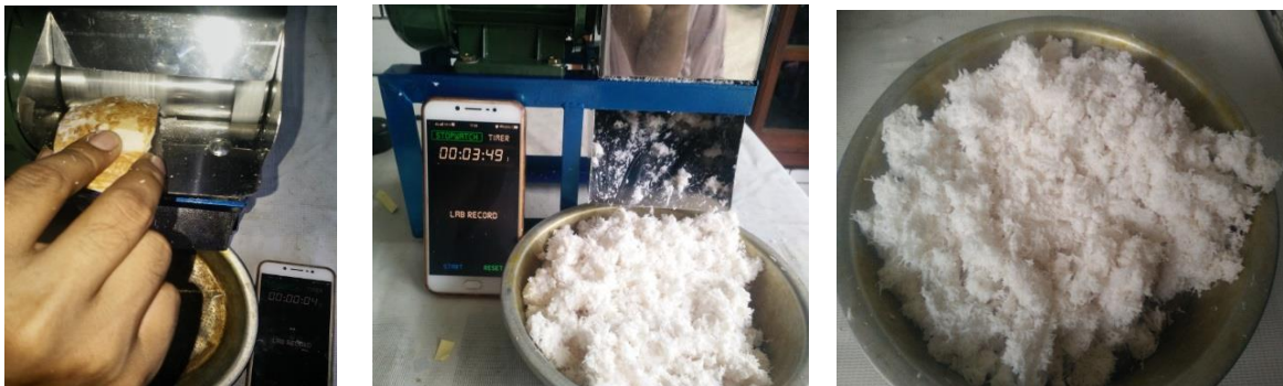
Gambar 7. Proses pengujian pamarutan kelapa dengan waktu
