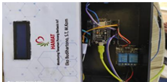
Gambar 6. Instalasi Monitor Suhu dan Kelembaban Tanah dalam Budidaya kentang.
