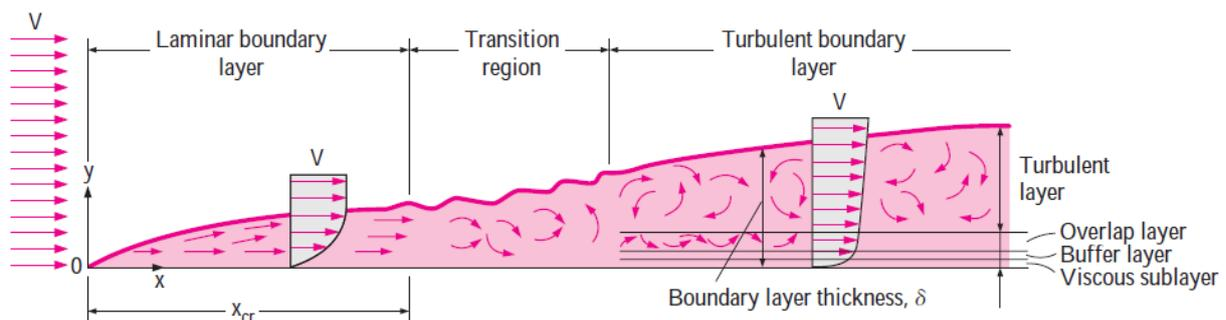
**Gambar 2.** Profil kecepatan aliran laminar dan turbulen
